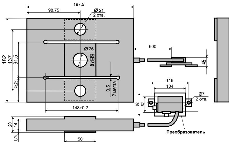
Рисунок 7 – Габаритные и присоединительные размеры ДСТЦ
