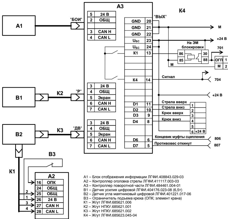
Рисунок Б.3 – Схема подключения ОНК-160С-38, -42 на кране
