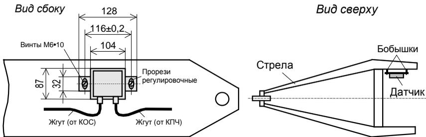
Рисунок 11 – Установка ДУГМЦ
