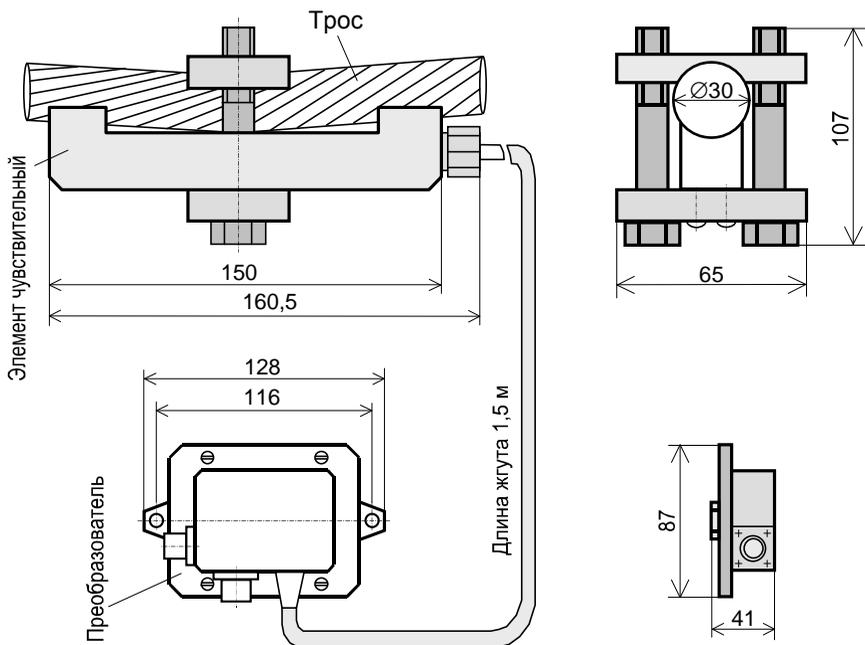
Рисунок 8 – Габаритные и присоединительные размеры ДУКЦ
