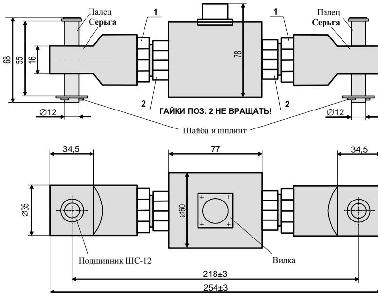
Рисунок 4 – Габаритные размеры ДУЦ-06
