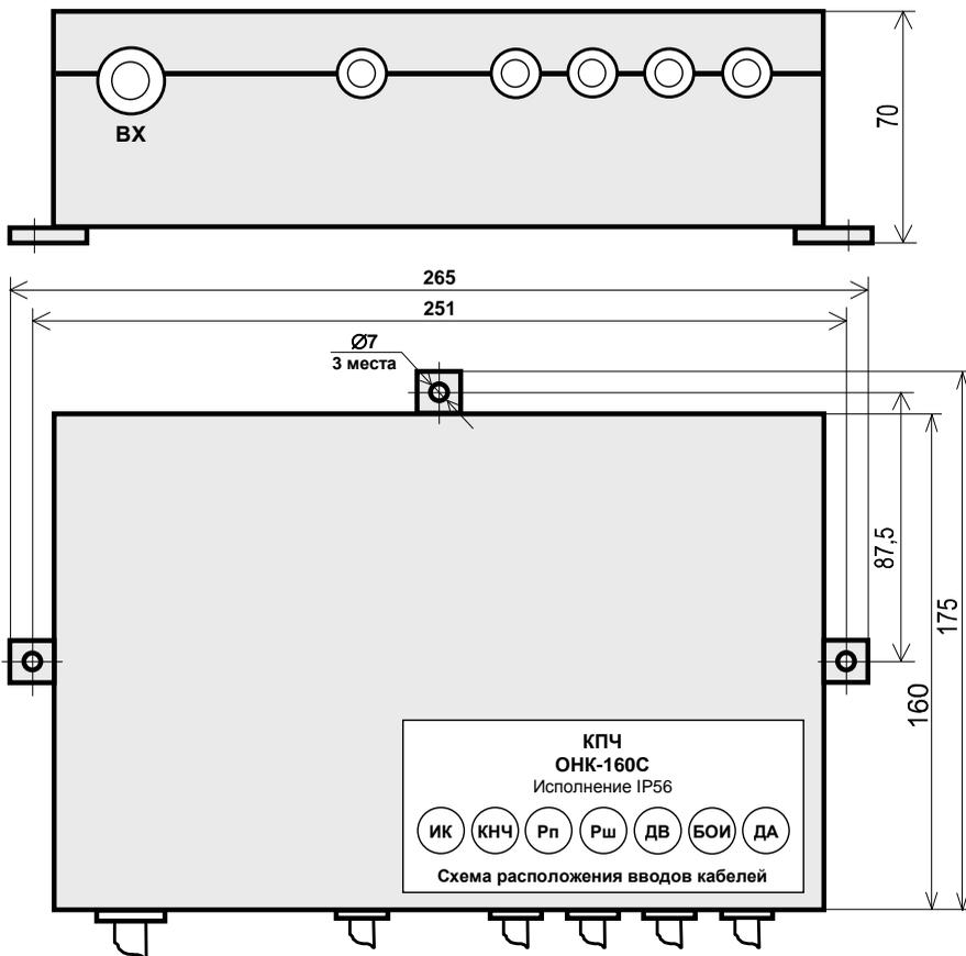
Рисунок 12 – Габаритные и присоединительные размеры КПЧ
