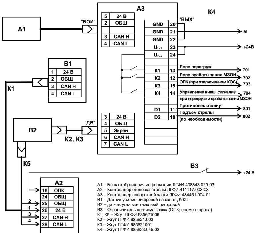
Рисунок Б.2 – Схема подключения ОНК-160С-29 на кране
