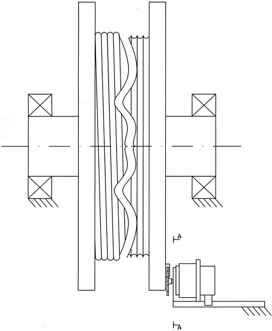
Рисунок 22 – Пример установки датчиков высоты, вылета или пути (вариант 2)
