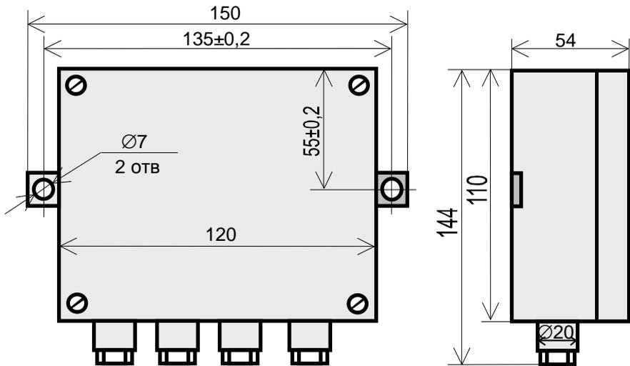
Рисунок 16- Габаритные и присоединительные размеры КБК и разветвителя
