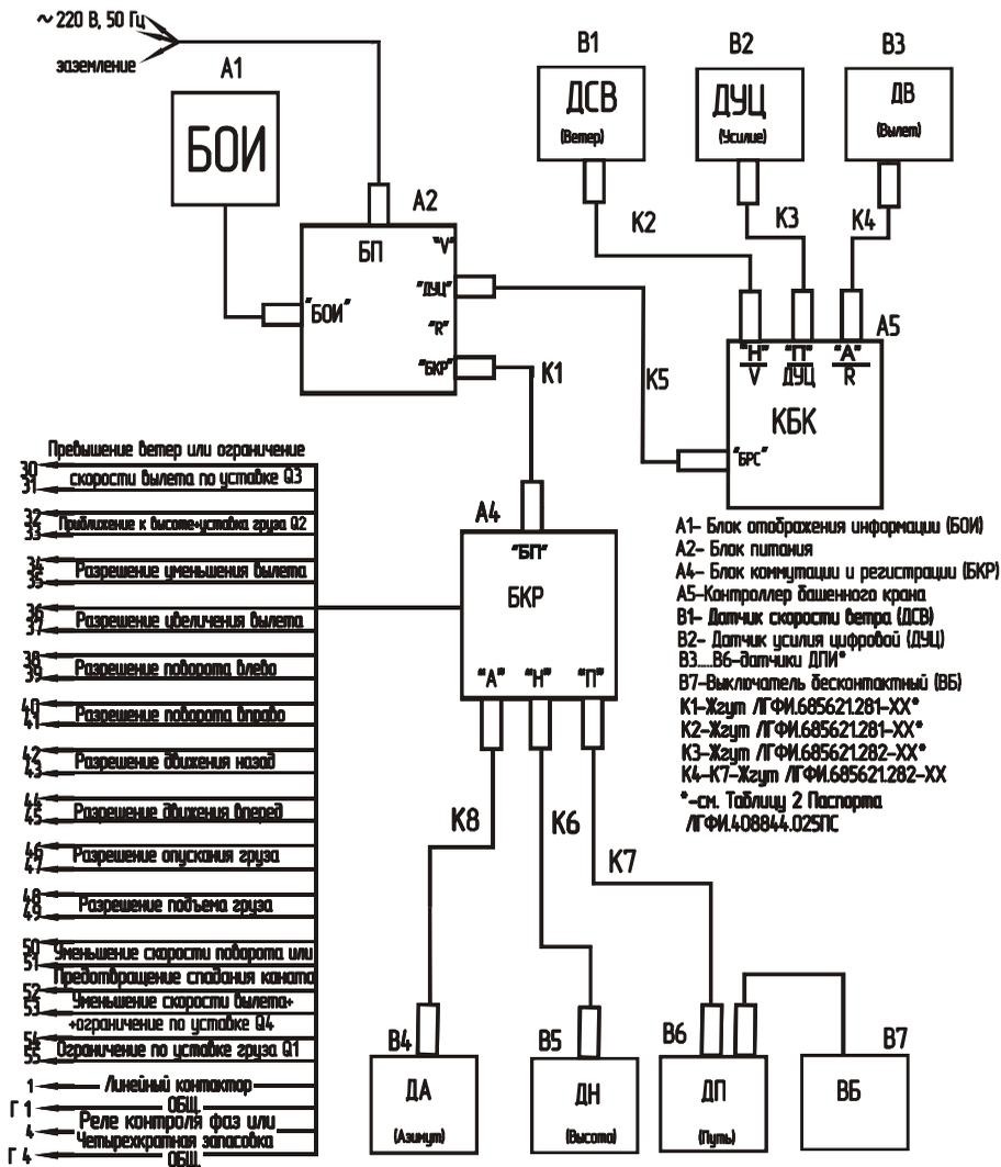
Рисунок 4 - Схема подключения к электрооборудованию крана составных частей ограничителя
