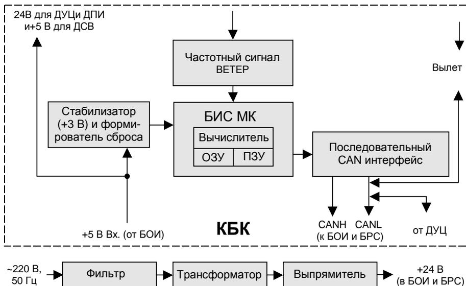
Рисунок 10 - Блок-схема БП
