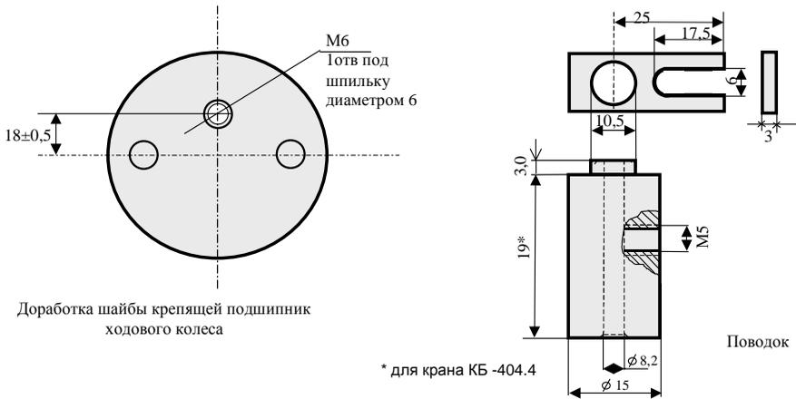
Рисунок 20 – Пример изготовления поводка для датчиков
