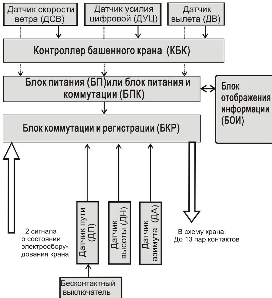
Рисунок 1 - Блок-схема ОНК-160Б
