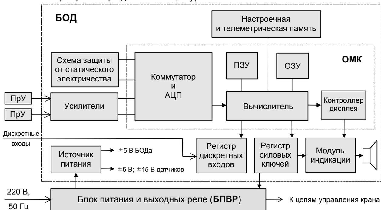
Рисунок 1- Блок-схема ограничителя
